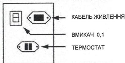
Рисунок 11. Підключення термостата, керування насосом
