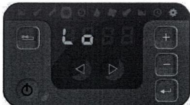
З подальшим натисканням кнопки
